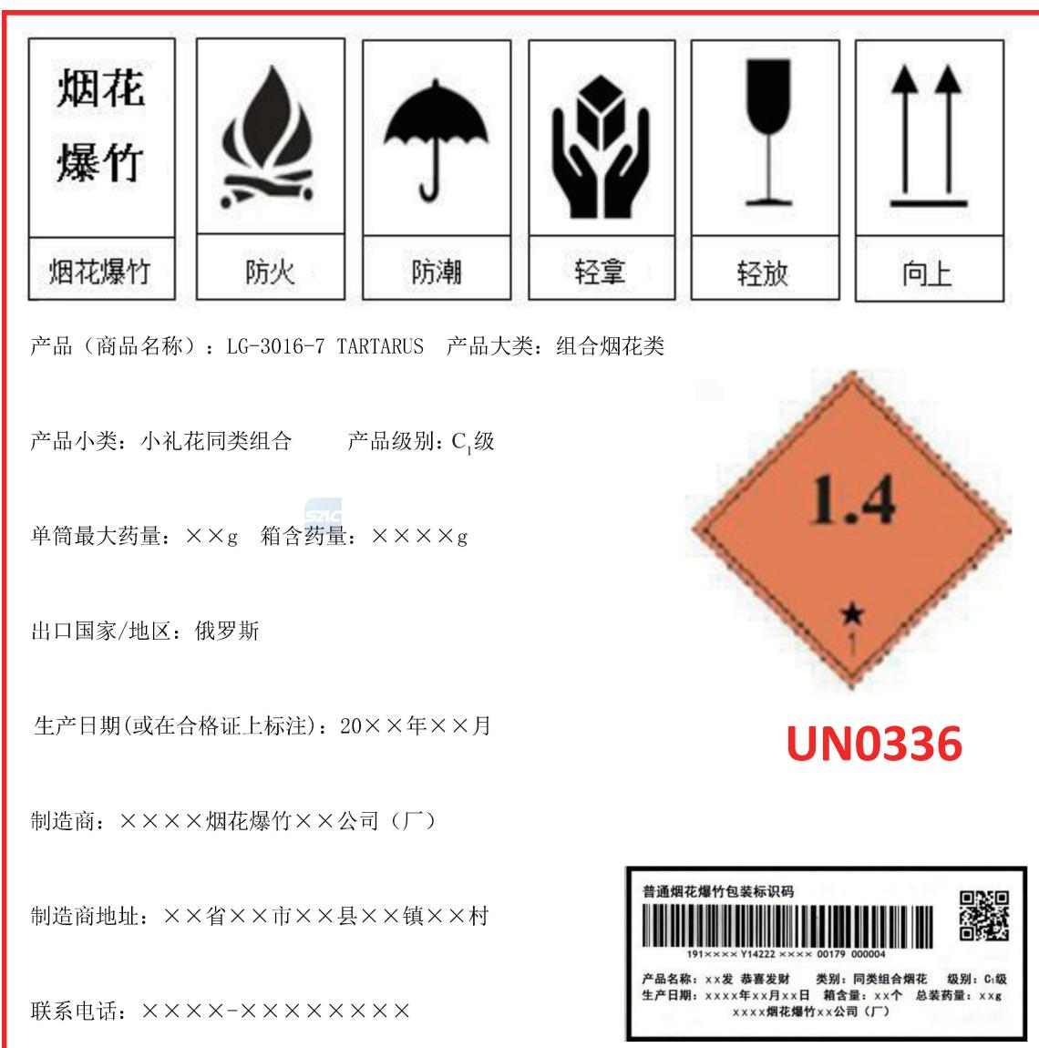
图 B.2 出口产品运输包装标志示例表
